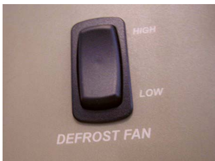
Defrost Fan Switch on dash
