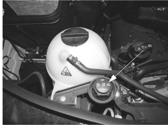
**Diesel Exhaust Fluid Fill**
